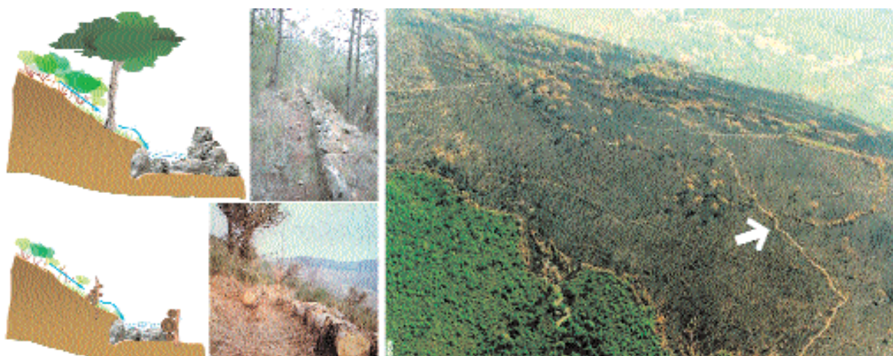
Fig. 18 - I canali di drenaggio. Dettaglio strutturale di scolina di guardia con arginatura in pietrame (in alto) o in legname (in basso). A monte delle scoline, specialmente nei casi di ripristino a seguito di incendi, possono essere presenti graticciate. Il tracciato delle scoline di guardia, coperto normalmente dal bosco, viene reso visibile a seguito di incendi; la freccia bianca nella foto a destra ne segnala una in località Campi (Calci). [Foto: F. Casella; schemi F. Casella e D. Rizzo]
